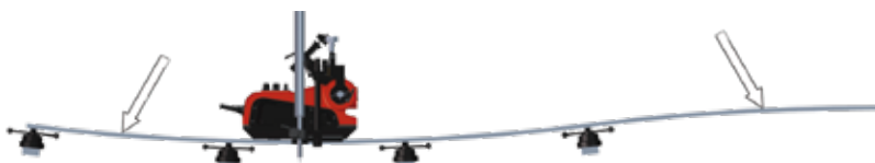
TRAC RL montato su binario flessibile, saldatura su un piano bombato
