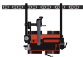
Saldatura: lato torcia sul lato della binario flessibile
