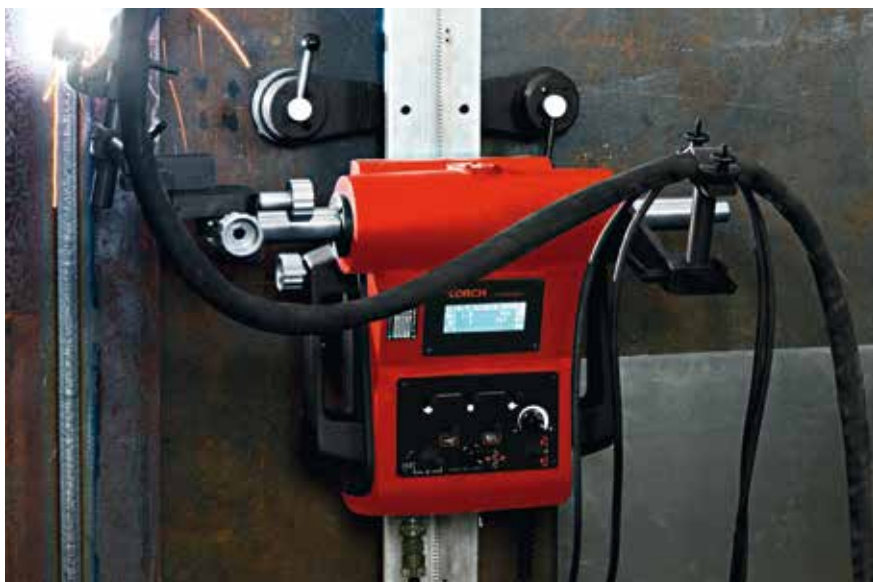
TRAC RL montato su binario flessibile, saldatura su un piano bombato
