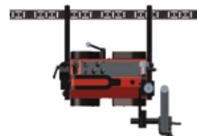
Saldatura con binario flessibile, torcia montata accanto al TRAC
