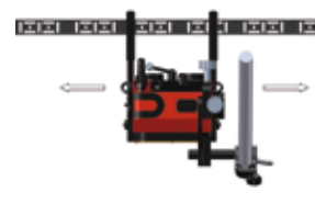
Saldatura con binario flessibile, torcia montata accanto al TRAC
