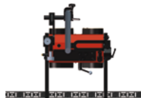
Saldatura: lato torcia opposto a quello della binario flessibile
