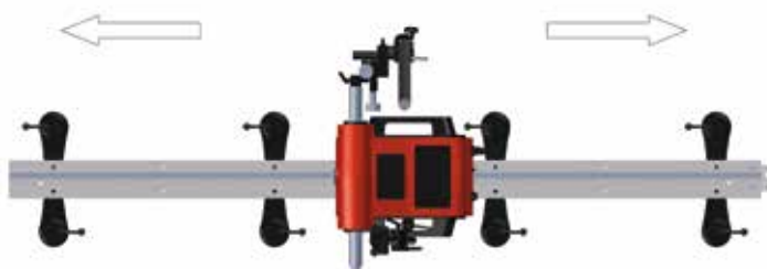
TRAC RL su binario guida, montato lateralmente (consigliati 7 supporti magnetici)
